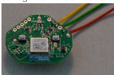
Figura 19: Connessioni modulo Bluetooth smartdoor
