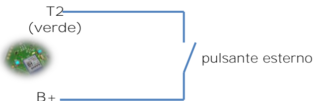
Figura 19: Connessioni modulo Bluetooth smartdoor
