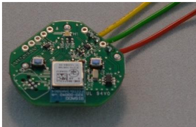
Abbildung 19: Anschlüsse smartdoor Bluetooth-Modul
