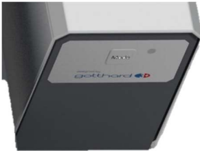
Abbildung 39: MODE Taster 10 Sekunden drücken, um ein RESET auszuführen
